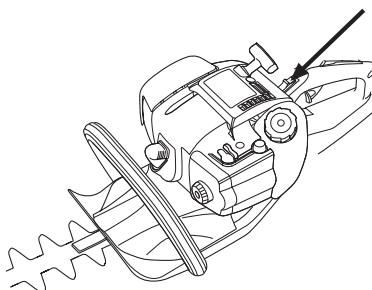
**ВНИМАНИЕ!** Контакт остановки автоматически возвращается в положение запуска. Во избежание непроизвольного запуска, колпачок зажигания следует всегда снимать со свечи зажигания при монтаже, проверке и/или обслуживании.
