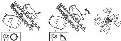
При правильной регулировке ножей, между ножами около болтов должен оставаться зазор в 0,2-0,4 мм.
