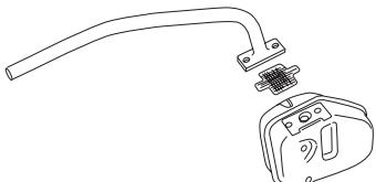
Если на вашем инструменте стоит глушитель такого типа, то сетку следует очищать не реже одного раза в неделю. На глушителях с катализатором, такую очистку достаточно производить раз в месяц. При возникновении повреждений на сетке ее следует заменить. Если сетка часто бывает засорена, значит функция катализатора ухудшена. Обращайтесь к нашему продавцу за советом. Засорение сетки
