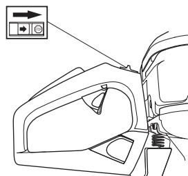
Запустите двигатель и проверьте, чтобы он остановился при переводе выключателя в положение стоп.
