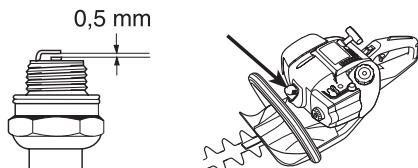
**ВНИМАНИЕ!** Всегда используйте только указанный тип свечи! Применение несоответствующей модели может привести к серьезным повреждениям поршня/цилиндра. Следите за тем, чтобы свеча была оснащена т.н. изоляцией радиопомех.
