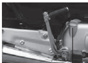
заправочная горловина масла в картер двигателя
