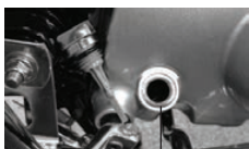
заправочная горловина масла в картер двигателя
