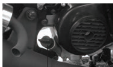
заправочная горловина масла в картер двигателя
